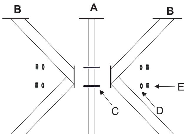
Saml stellet løst uden at stramme boltene. placer stellet, i midten og skru det i bord pladen, med F skruerne, herefter strammes boltene på selve stellet. Brug juster skruerne under stellet til bordet er stabilt.
